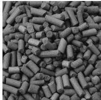
Гранулы из активированного угля могут очищать сжатый воздух и газы с помощью адсорбционного процесса и в основном используется для отделения паров масла от потоков сжатого воздуха. Активированный уголь можно использовать для других aplicación в соответствии со спецификой. Типичным использованием активированного угля является очистка природного газа, реформинг газа и воздуха.
