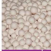
Адсорбент SORBEO MS4 является высокопористым, кристаллическим алюмосиликатом в форме шариков. Поры в отверстиях имеют диаметр приблизительно 4 Å. SORBEO MS4 является продуктом для динамической сушки большинства газов и паров. Он может также использоваться для удаления других примесей с диаметром молекул меньше 4 Å. Типичные области применения для адсорбента SORBEO MS4 сушка / очистка природного газа, реформинг газа и воздуха.
