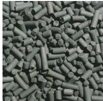
Sorbeo CMS представляет собой гранулированную форму молекулярного сита CMS в основном используется для отделения N<sub>2</sub> от воздуха, но также может использоваться в многих других условиях (выделение метана из метана / CO<sub>2</sub> или этилена из смеси этиленовых смесей ...). Типичным применением для активированного угля являются разделение Кислород / Азот.
