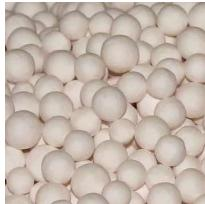
Адсорбент SORBEO MS10 представляет собой высокопористый, кристаллический алюмосиликат в форме шариков. Поры в отверстиях имеют диаметр около 10 Å. Из-за его высокого объема поглощения воды и CO<sub>2</sub>, это молекулярное сито широко используется для очистки воздуха при криогенной сепарации воздуха. Он также применяется при удалении H<sub>2</sub>S / меркаптанов и других соединений серы из природного газа и LPG.
