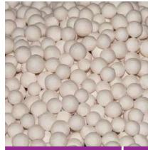
Адсорбент SORBEO MS3 представляет собой высокопористый, кристаллический алюмосиликат в форме шариков. Поры в отверстиях имеют диаметр около 3 Å. Адсорбент был специально разработан для сушки этилена в трещине. Кроме того, пропилен, бутадиен и другие ненасыщенные углеводороды сушат, используя это молекулярное сито. Адсорбент также используется для сушки газов, содержащих H<sub>2</sub>S и CO<sub>2</sub>, где образование COS должно быть сведено к минимуму.
