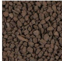
Катализатор SORBEO HC предназначен для катализитического окисления CO из CO<sub>2</sub> в сухом воздухе или других газах. Таким образом, ядовитый CO удаляется и вместо него образуется CO<sub>2</sub>. Этот процесс используется в таких приложениях, как сжатиедыхательного воздуха, респираторах, защитных масках и очистка криогенного газа.
